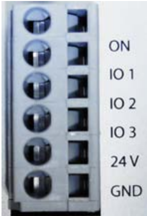
Abb. 63: Klemmleiste X5 – digitale Ein/Ausgänge (ECOsine® active 30/50/60/100/120-xxx-x)
